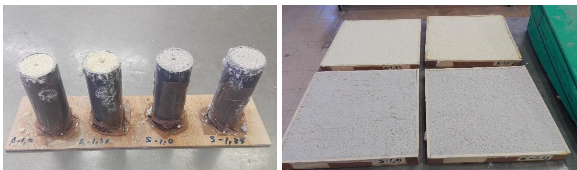
Figura 3.3 Provetes utilizados na terceira produção de argamassas.
