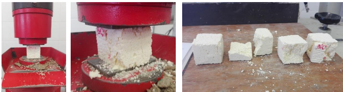
Figura 3.9 Realização do ensaio da resistência à compressão.
