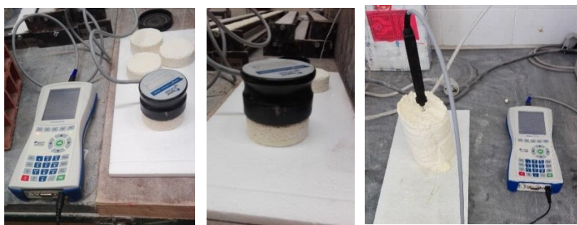
Figura 3.7 Ensaio da condutibilidade térmica com a sonda de contacto e de agulha.
