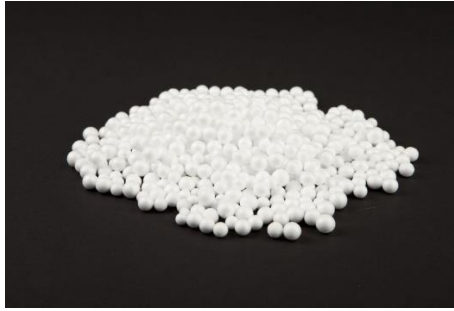
Figura 2.7 Granulado de poliestireno expandido (EPS) [W6].
