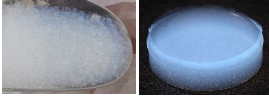
Figura 2.9 Aerogel de sílica no estado granulado e em placa [W10].
